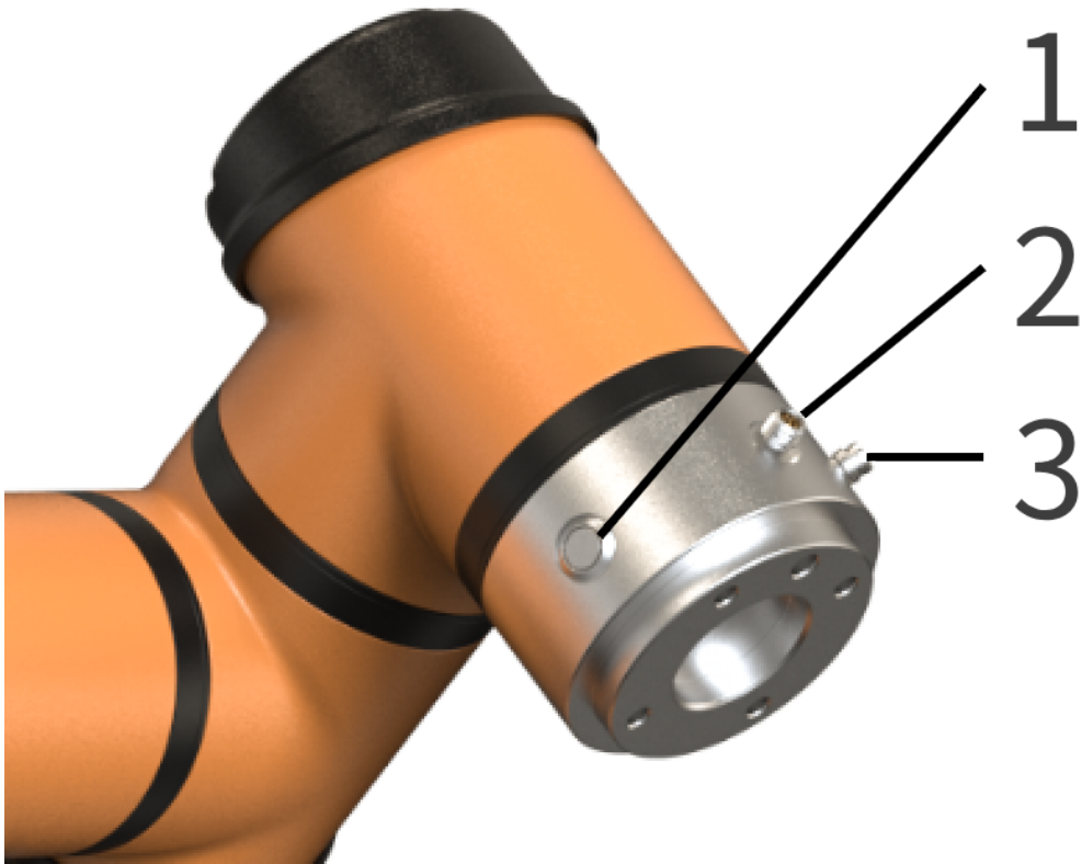
图 4-3 臂侧接口与按钮示意图
