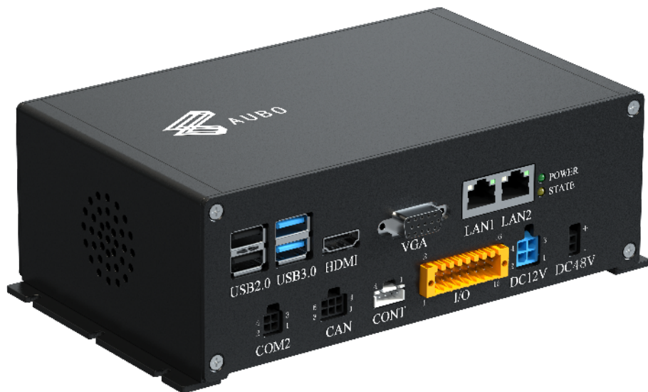
图 6-1 直流 48V 控制器
