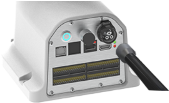
图 12-4 电缆连接至机器人一体化底座
