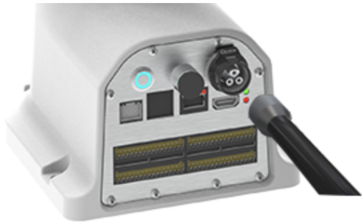
图 12-4 电缆连接至机器人一体化底座
