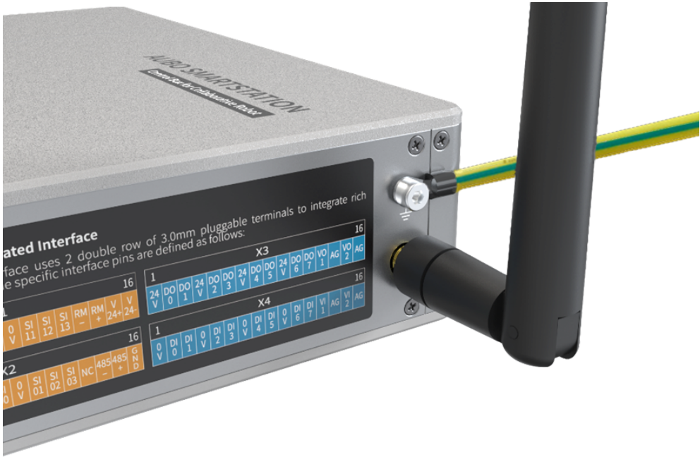
图 6-7 连接接地螺钉
