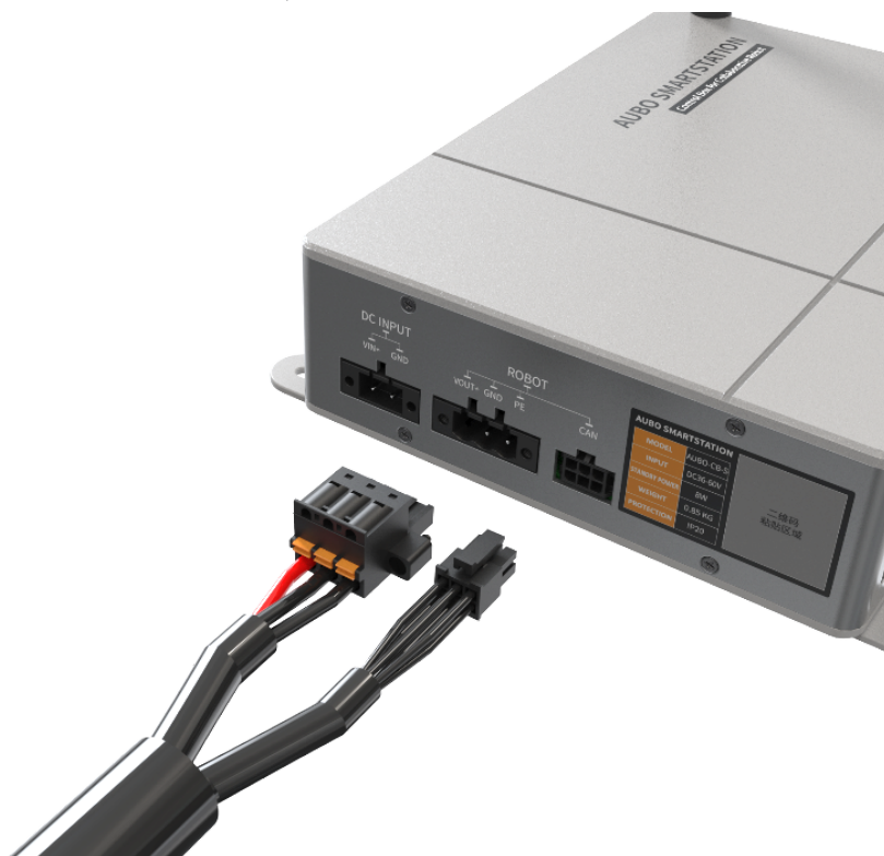
图 6-5 机器人本体电缆连接至控制器
