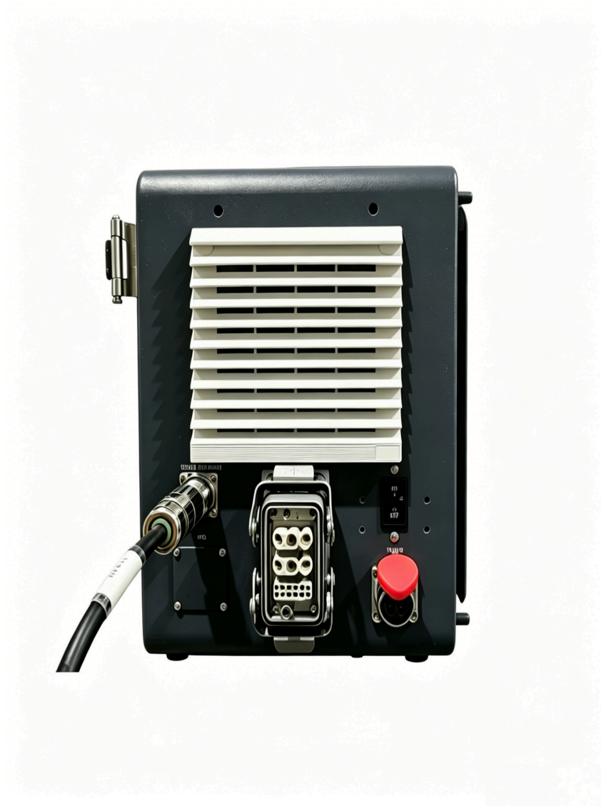
图 6-5 手柄或示教器连接至控制器
