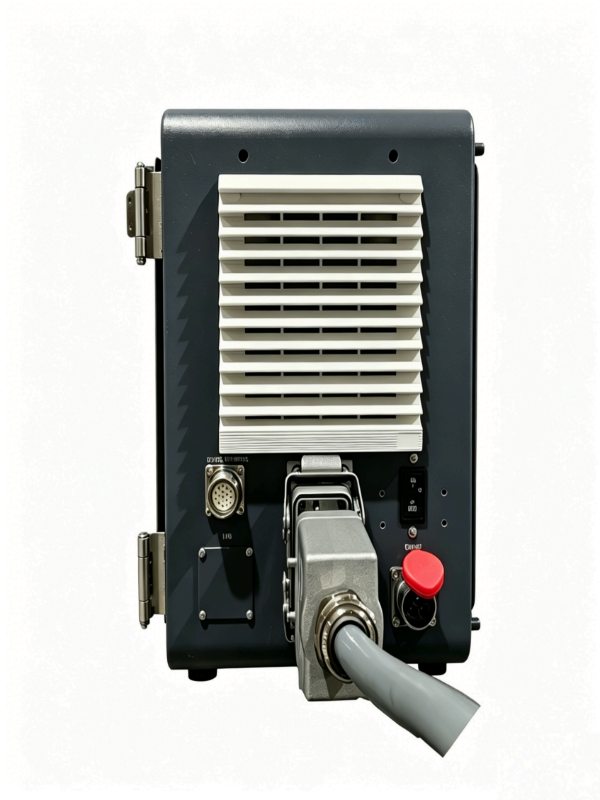
图 6-4 机器人本体电缆连接至控制器
