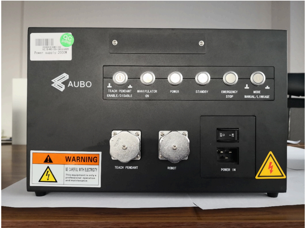
图 6-6 示教器使能开关位置
